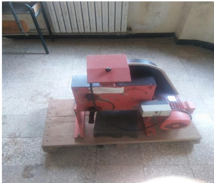
**Figure 14** : Concasseur à mâchoire type de laboratoire
