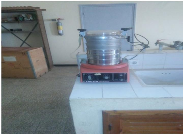
**Figure 16 :** Tamiseuse de laboratoire.
