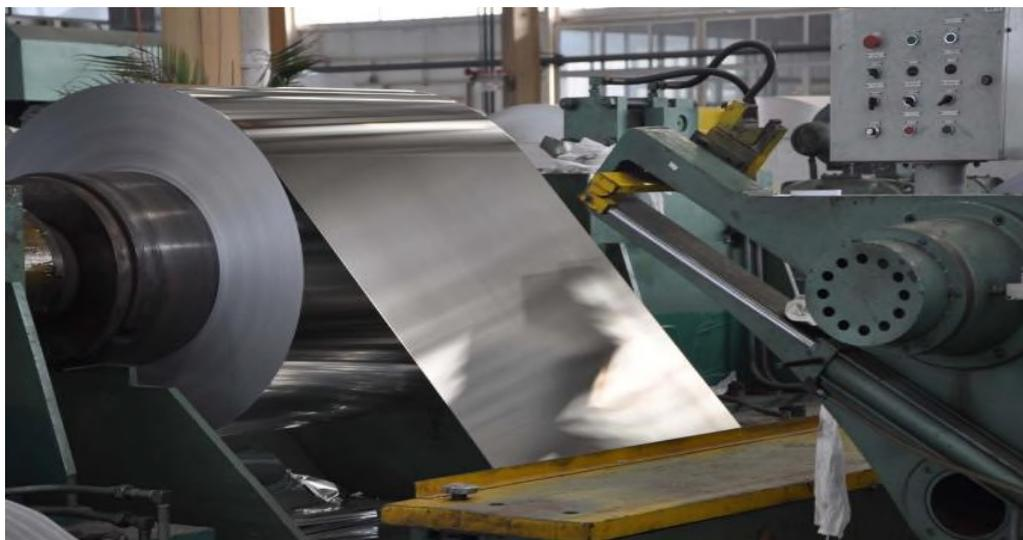
**Figure 12** :bobine de laminage à froid. [44]
