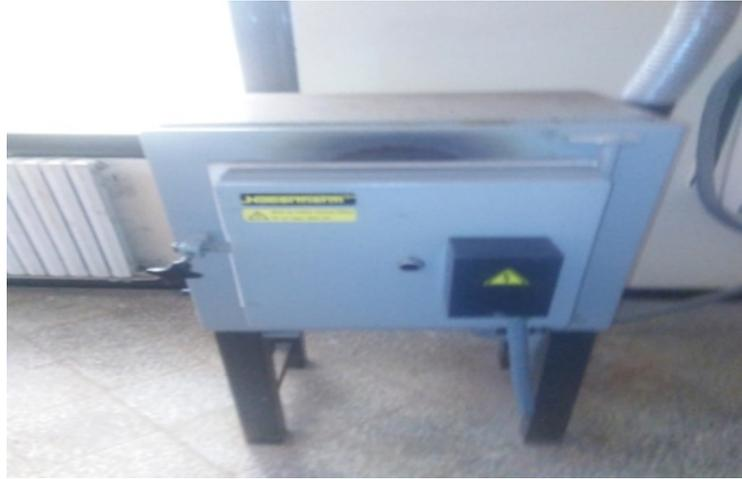
**Figure 23:** Four utilisé pour le grillage magnétisant.
