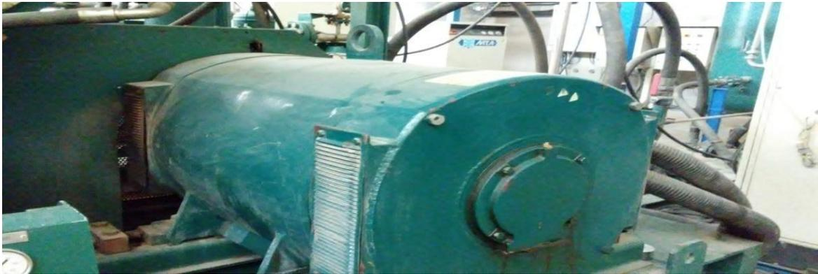
**Figure II.20 :** Moteur d'entraînement série SCe 315-355.
