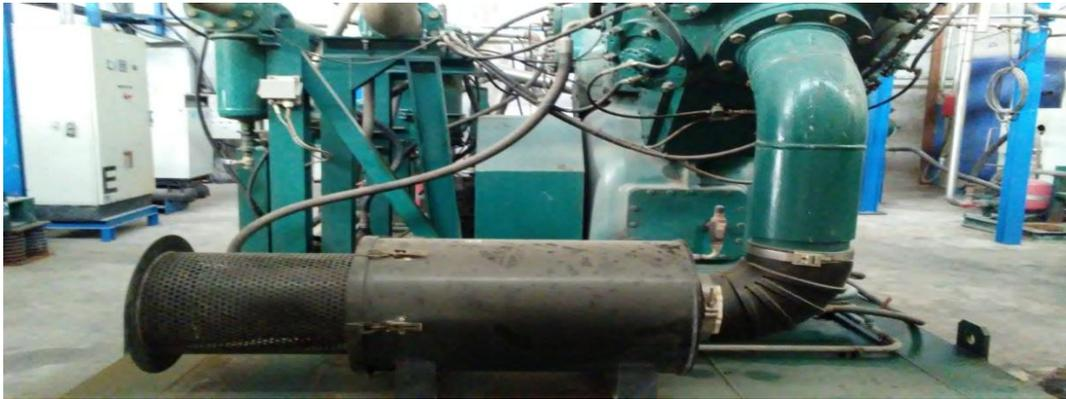
**Figure II.12:** Filtre à air.
