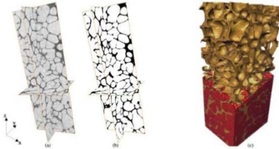
Figure II.1 Microstructure d'un réfractaire électro-fondu zircone-verre caractérisée par microtomographie [40]. Volume représenté :  $350 \times 350 \times 700 \mu\text{m}$ , (a) Segmentation du volume pour séparer les phases en présence. (b) Détection de l'isosurface, et triangulation. (c) Maillage obtenu (éléments tétraédriques linéaires, 1 500 000 degrés de liberté). La zircone est ici en rouge, et la phase vitreuse en jaune.
