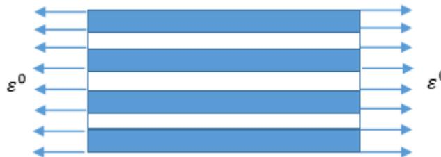
Figure I.12 Direction utilisée par la limite Voigt pour calculer la rigidité du composite
