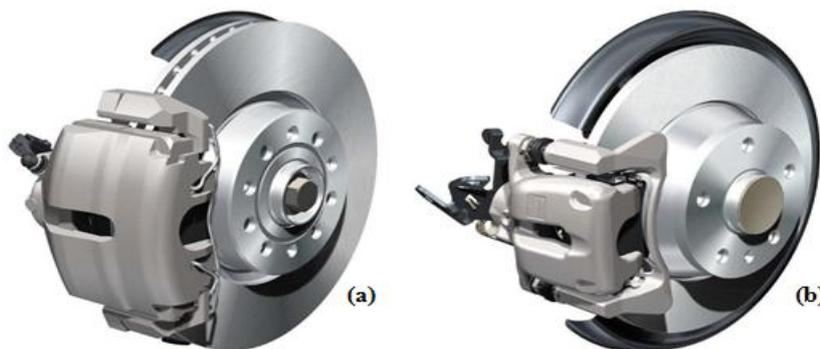
**Figure II.16 :** Disque de frein avant (a) et arrière (b) [13].
