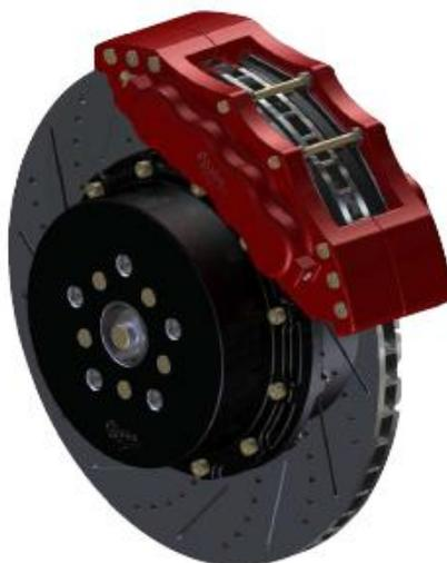
**Figure I.13 :** Illustration d'un frein à disque.
