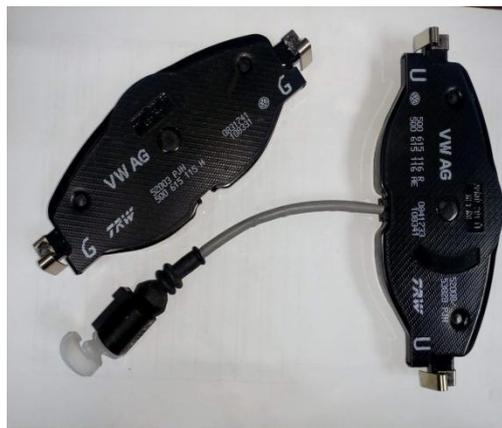
**Figure II.18 :** Plaquettes de frein de Volkswagen avec capteur.
