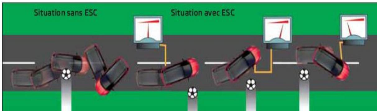
**Figure II.10 :** Comportement de véhicule avec ou sans ESP dans un Manœuvre d'évitement.
