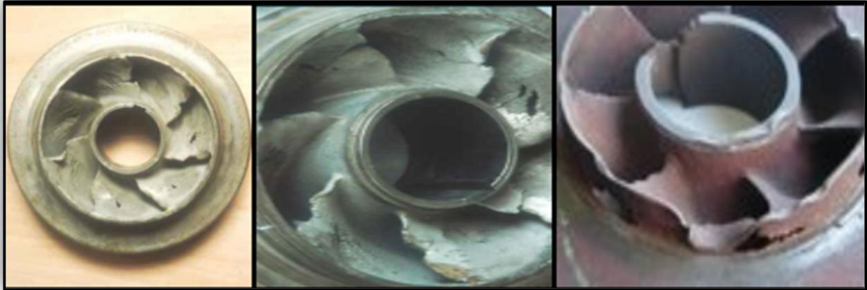
**Figure (V.2) :** Photos illustrant le phénomène de cavitation sur des aubes d'une pompe centrifuge
