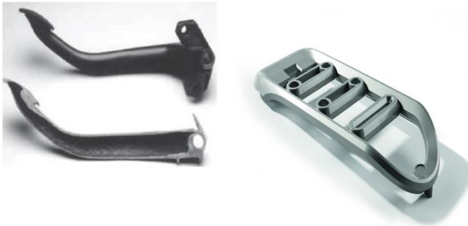
Figure I.4 - Injection à Gaz.
