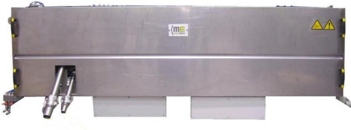
Figure II. 22: Le réservoir de colle
