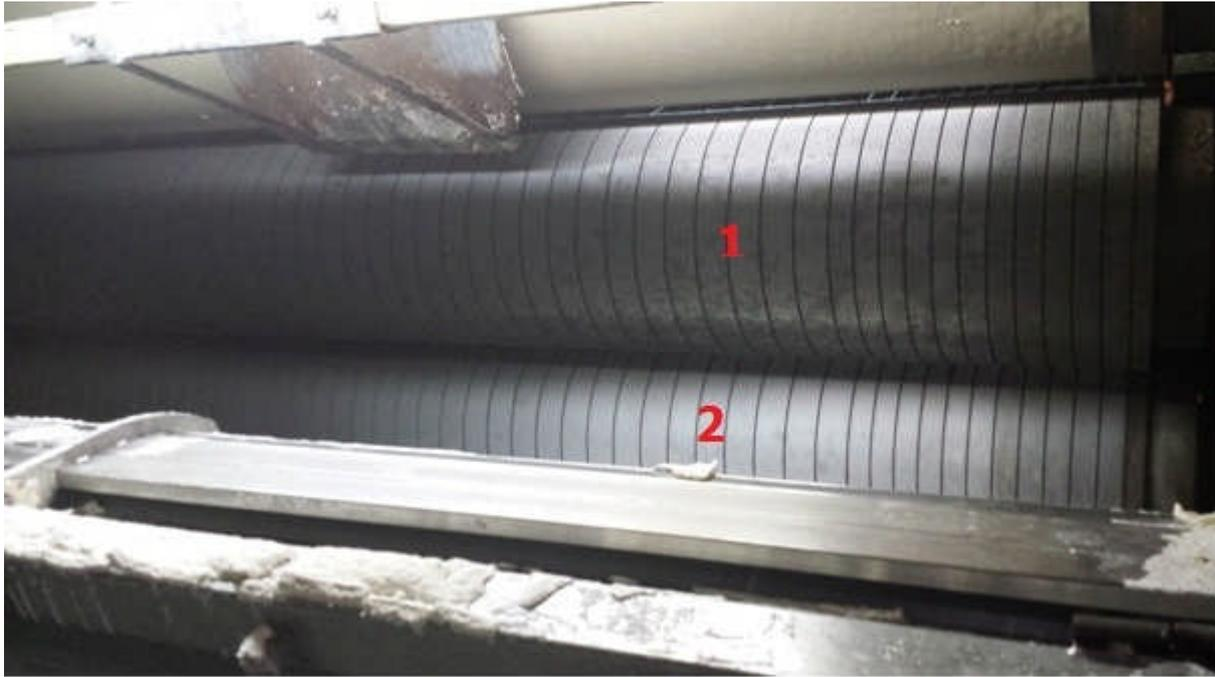
Figure II. 17: les cylindres onduleurs
