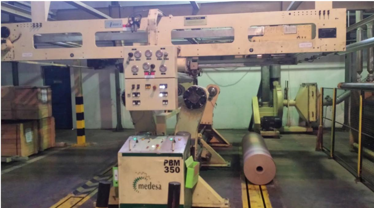
Figure II.6: le PBM 350 porte bobine [1].
