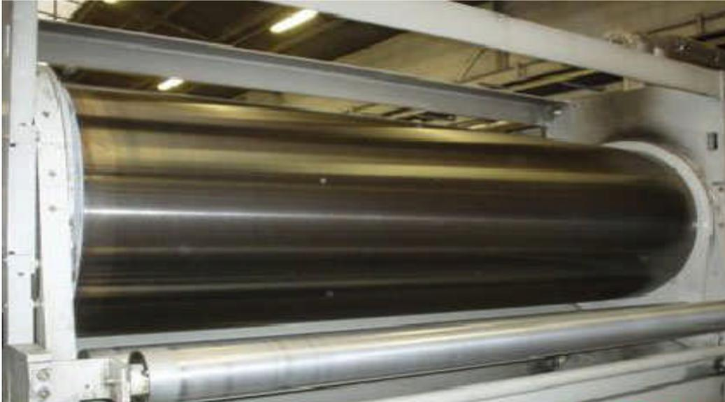
**Figure II. 1 : un pré conditionneur de diamètre 600 mm [1]**
