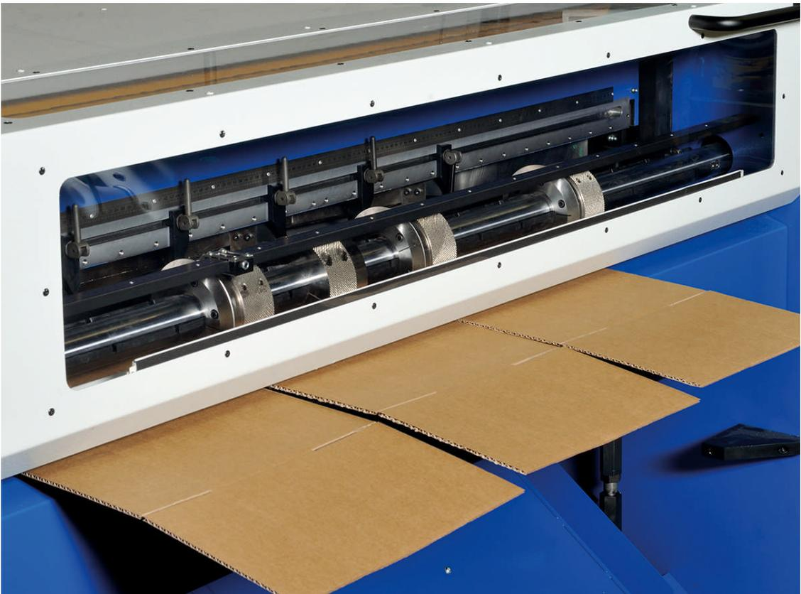
Figure II. 11: image montrant une découpeuse transversale semi automatique
