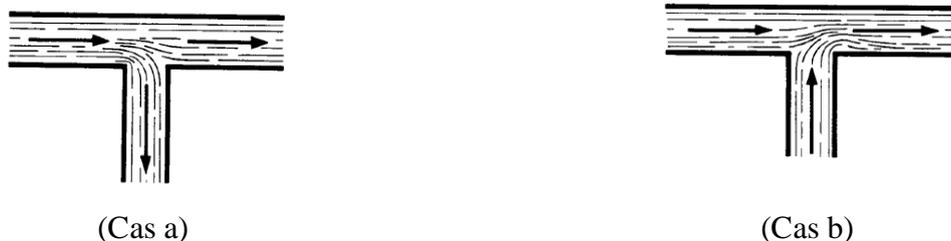
Figure (III.7) : Té avec réunion ou séparation des débits de même diamètre que la conduite rectiligne.
