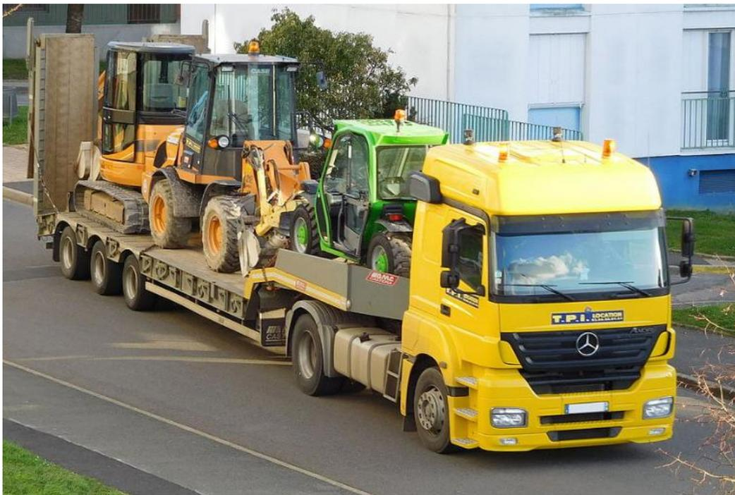
**Figure I.3** : Une semi-remorque porte engin [01]
