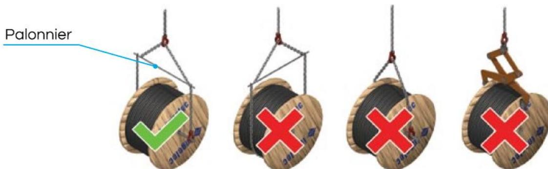
**Figure II.2.** Les méthodes à éviter lors de levage d'un touret. [02]
