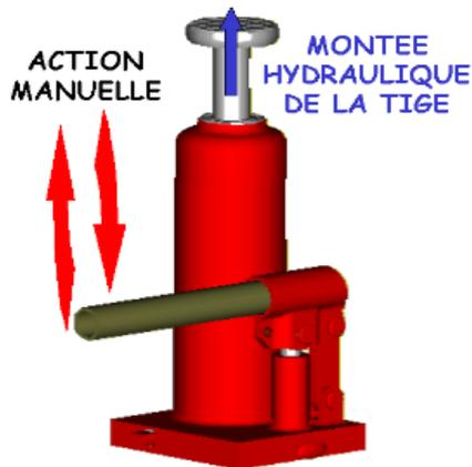
Figure III.11 : La tige de cric en cours de monter. [08]
