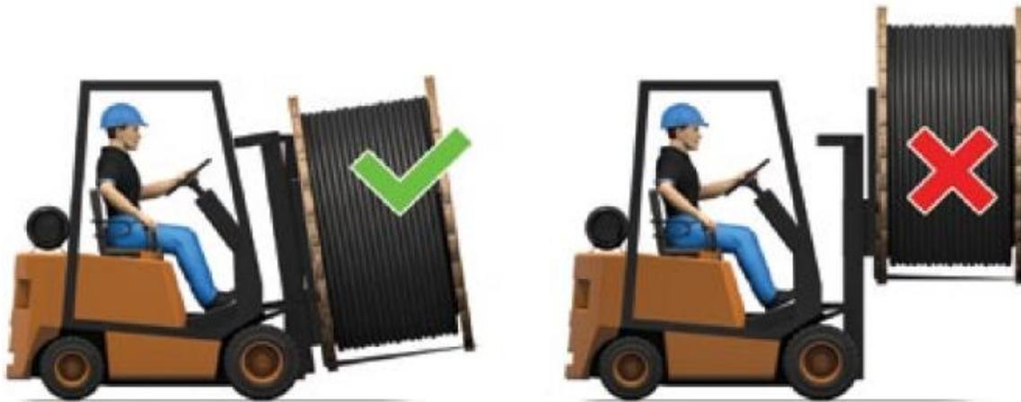
**Figure II.1 :** La méthode de manutention du touret à l'aide un chariot élévateur. [02]
