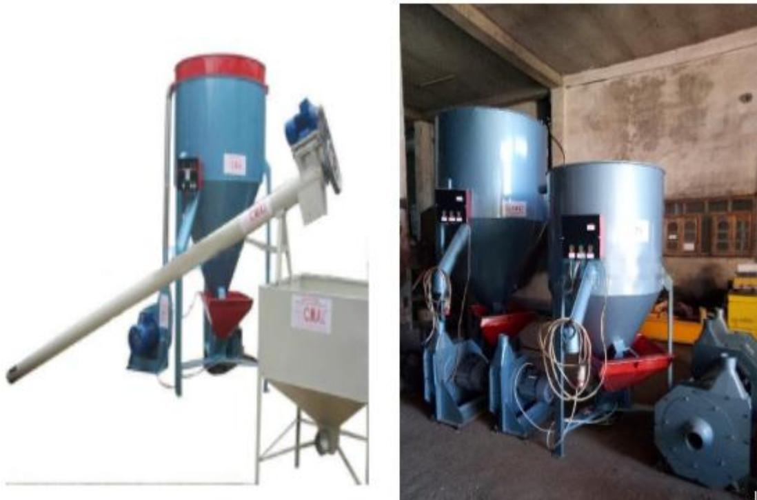
**Figure I.1 :** Un broyeur mélangeur d'aliment de bétail fabriqué par l'entreprise C.M.A.I
