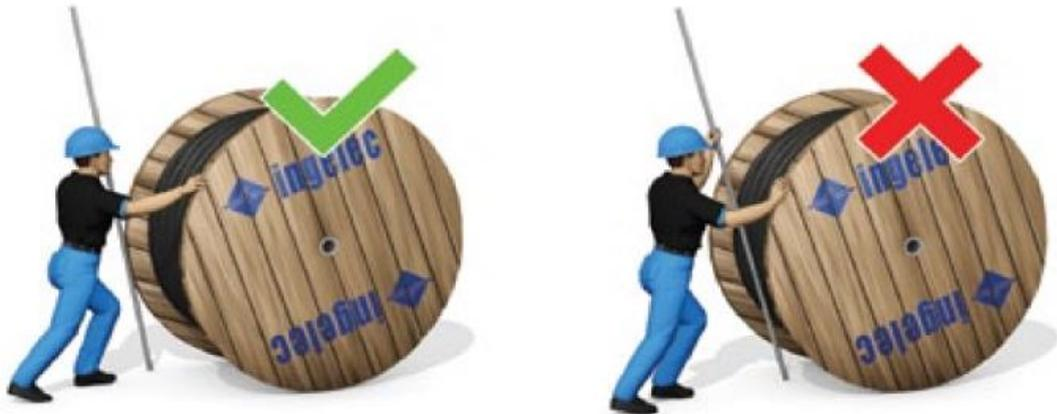
**Figure II.3** : Les différentes méthodes pour déplacer un touret à l'aide d'un dispositif manuel.[02]
