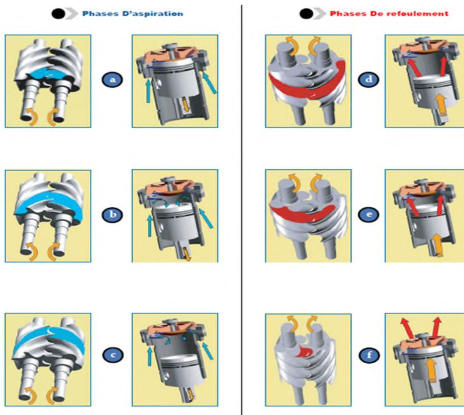
Figure II.4 Les phases de compresseur à vis [18].
