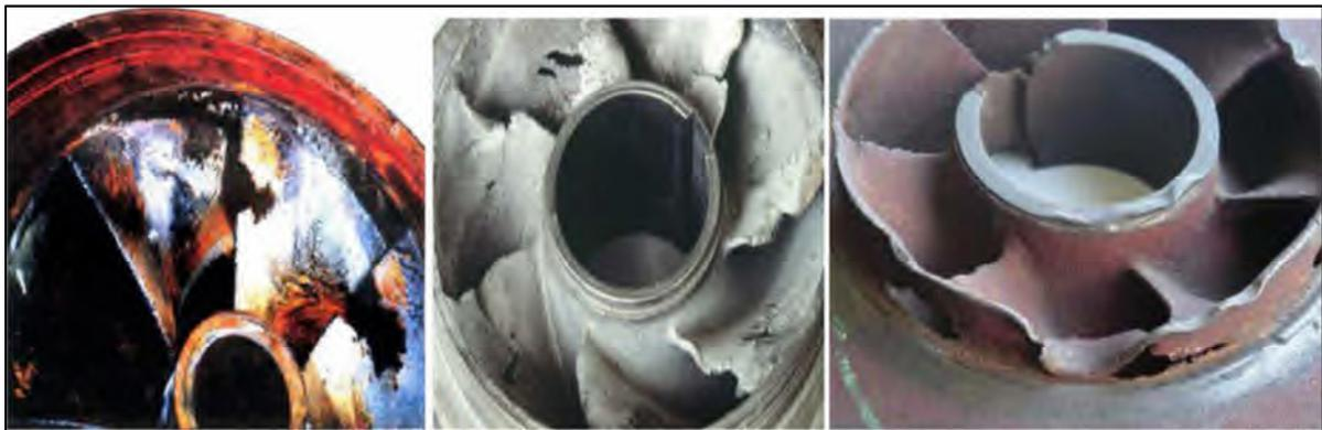
**Figure (IV.3) : Érosion par cavitation sur les aubes d'une pompe centrifuge.**
