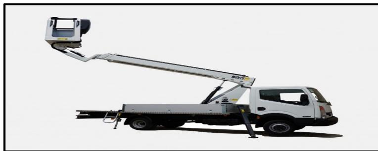
**Figure I.3 :** Nacelle élévatrice sur camion.
