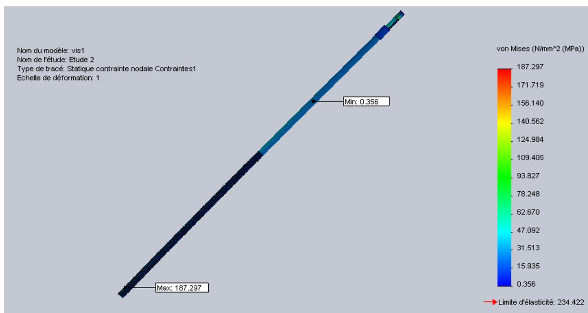
Figure IV.22 : Distribution des contraintes de Von Mises sur la vis.
