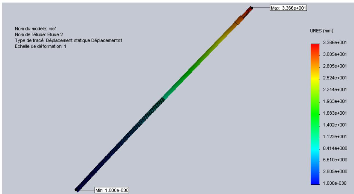
Figure IV.24 : Les déplacements sur la vis.
