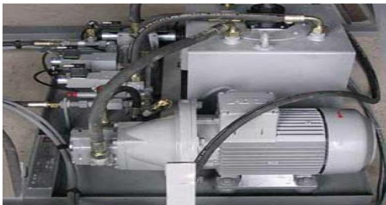
**Figure I.13** : Le groupe hydraulique [5].
