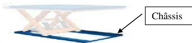
Figure I.9 : Châssis de base d'une table élévatrice.
