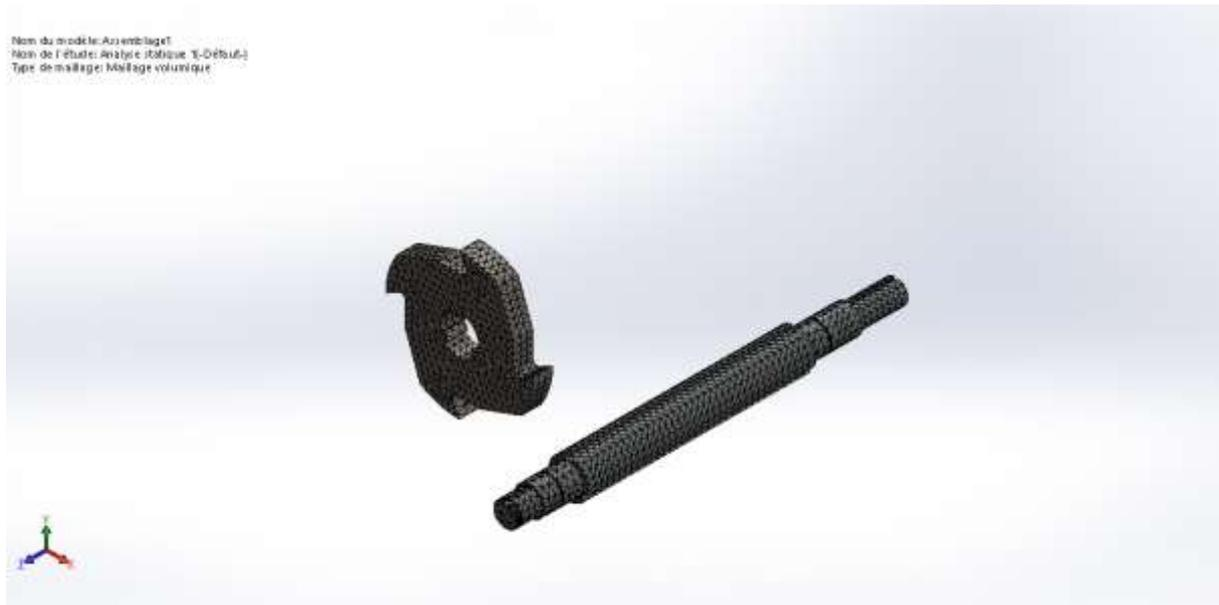
Figure (40) : Le maillage des pièces du broyeur
