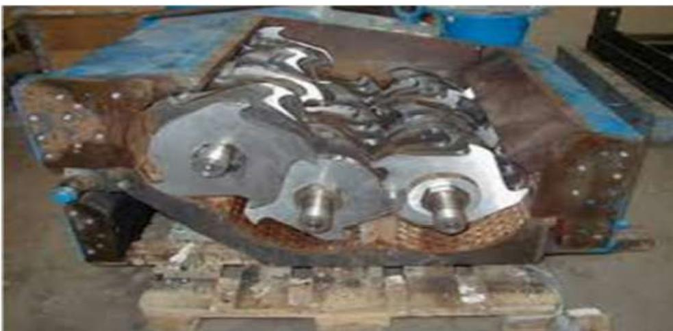
**Figure (11):** Déchiqueteur à cisaille rotative avec 3 axes à grille de calibrage.
