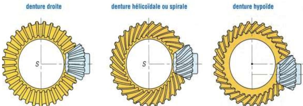
**Figure (30) :** Transmission par engrenage conique.
