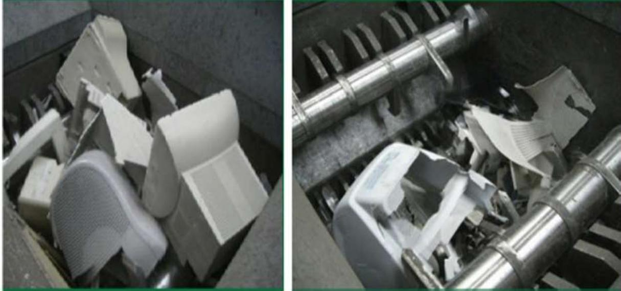
**Figure (12):** Lacérateur à 4 axes
