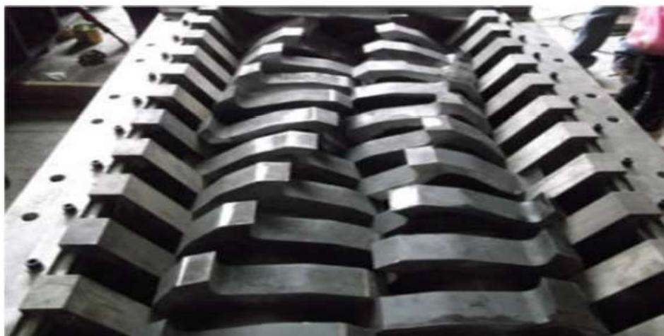
Figure (7): broyeur pour carton.
