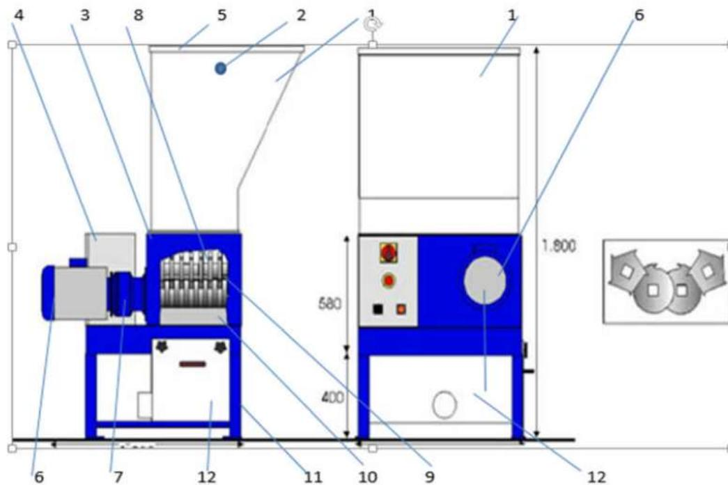
Figure(13) : Les différents éléments d'un broyeur plastique.
