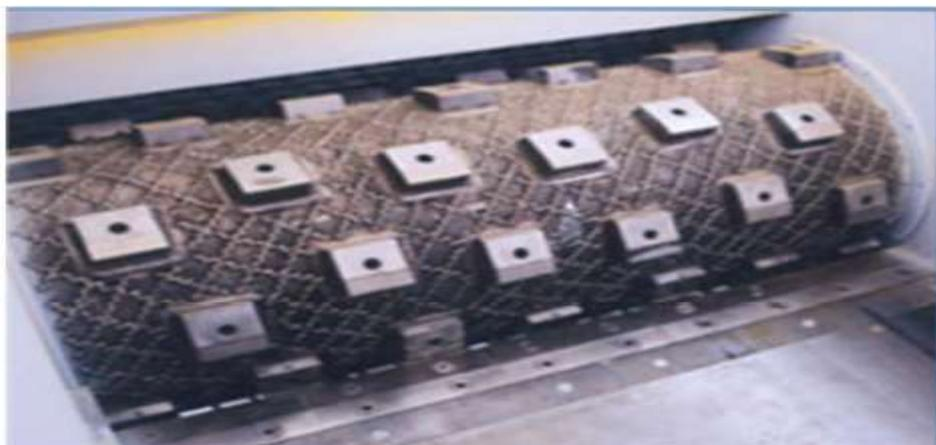
**Figure (9):** Déchiqueteur mono rotor à grille de calibrage
