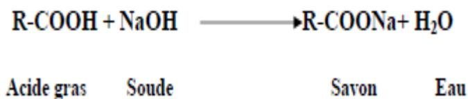
**Fig. I.8.** : La réaction de saponification
