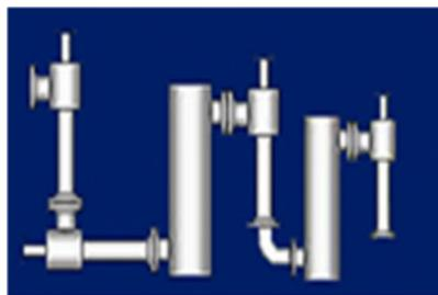
**Figure III. 6 :** Ejecteurs à 4 étages (1er étage de type sans condensation).[11]
