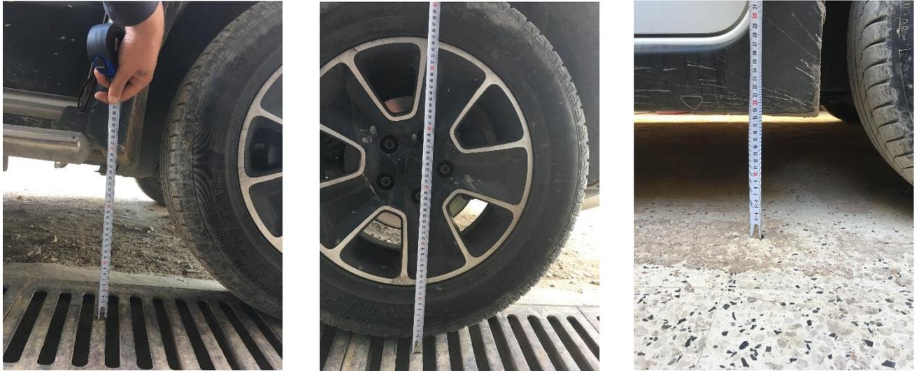
Figure II.3 : Mesure de la hauteur de véhicule par rapport au sol
