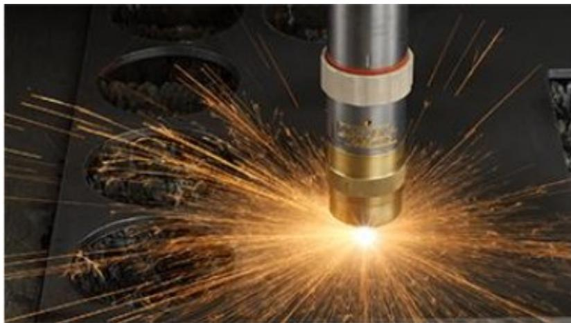
**Figure II.3:** systèmes de plasma « précision »
