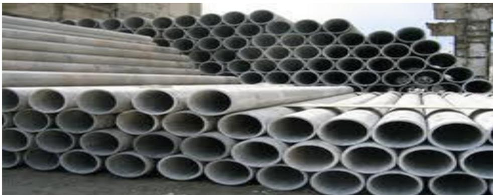
*Fig I.8. Conduites en amiante-ciment.* (BEGGAS et LIHIU, 2014)
