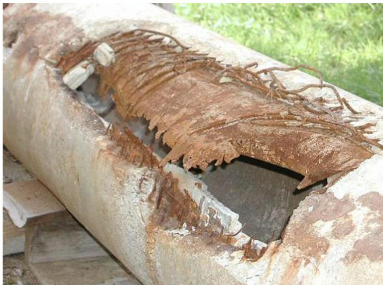
*Fig II.1. Dégradation structurelle d'une conduite d'assainissement. (MECHRI et al, 2010)*
