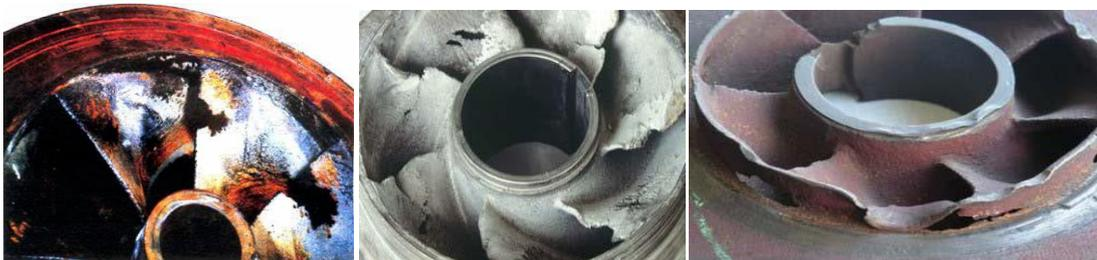
**Figure (IV .5) : Érosion par cavitation sur les aubes d'une pompe centrifuge**
