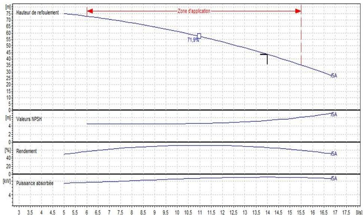
**Figure(IV.14) : Courbes caractéristiques de la pompe et de la conduite de forage (1)**
