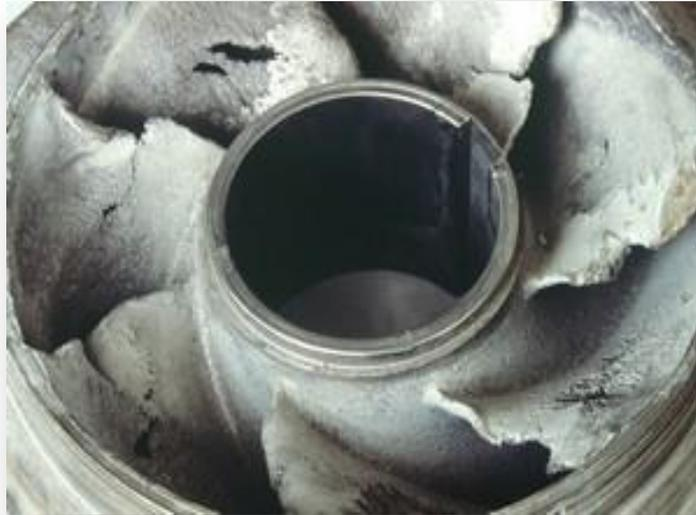
*Figure (V.3): Photo illustrant le phénomène de cavitation sur des aubes d'une pompe centrifuge.*
