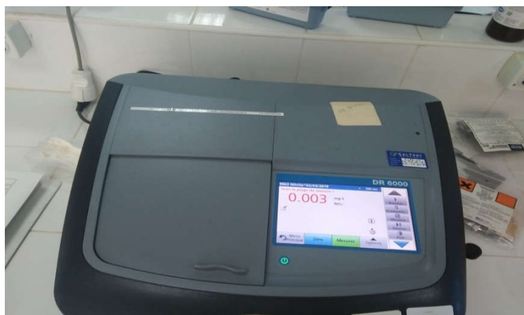
Figure (III.11): Appareil HACH (Photo prise au niveau de la SEAAL, Tizi Ouzou).
