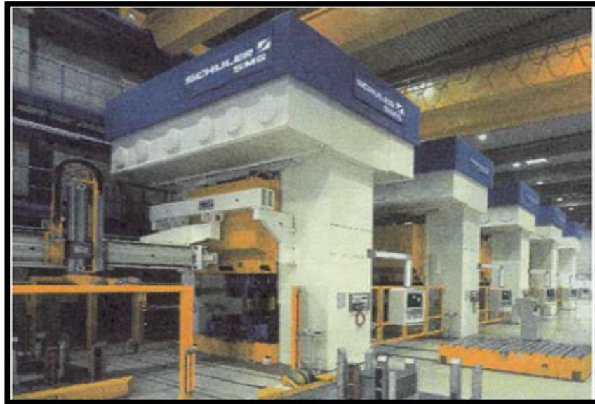
Figure I.11. Ligne de presses d'emboutissage [17].
