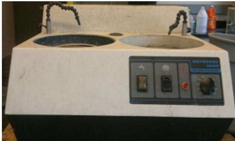
**Figure II.14:** photo d'une Polisseuse.
