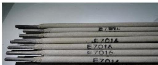
**Figure II.2:** photo d'un EE basique.
