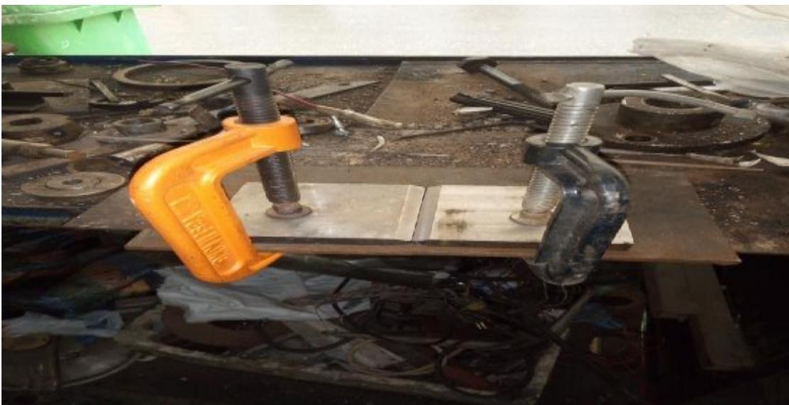
**Figure II.4 :** bridage des plaques.
