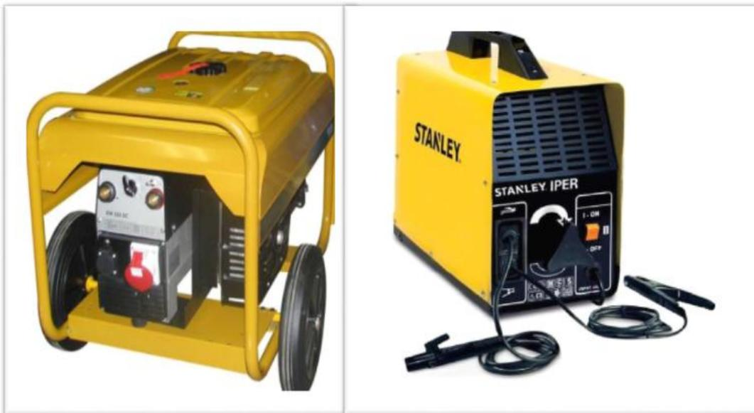
**Figure I.7** : Les différents types de générateurs de soudage.
