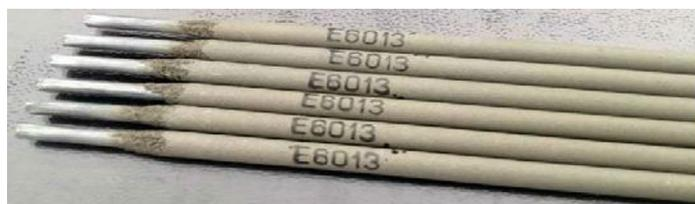
Figure II.1 : photo d'un EE rutile.
