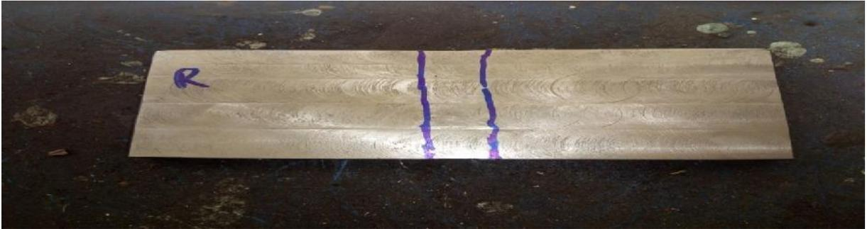
**Figure II.6** : forme de la maquette soudée avec EE du type rutile après fraisage.
