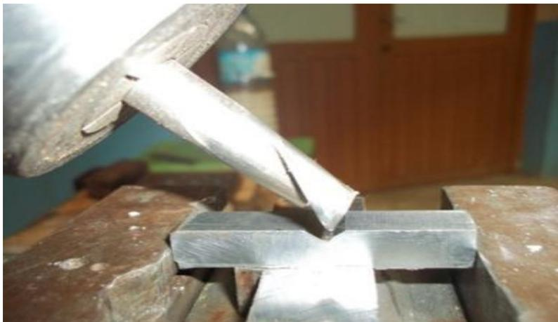
**Figure II.9** : réalisation de l'entaille avec un angle de  $45^\circ$ .
