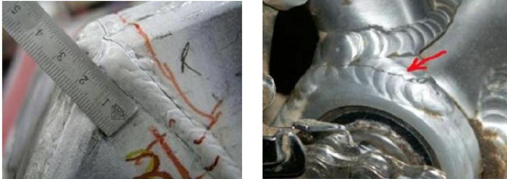
**Figure I.11** : Exemples de fissures [12].
