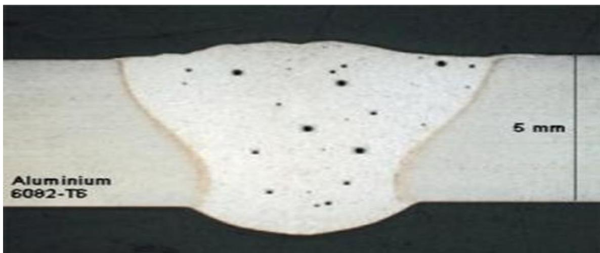
**Figure I : 14**– Exemple de soufflures.
