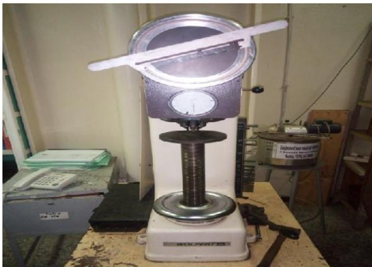
Figure II.11: photo de duromètre Brinell.
