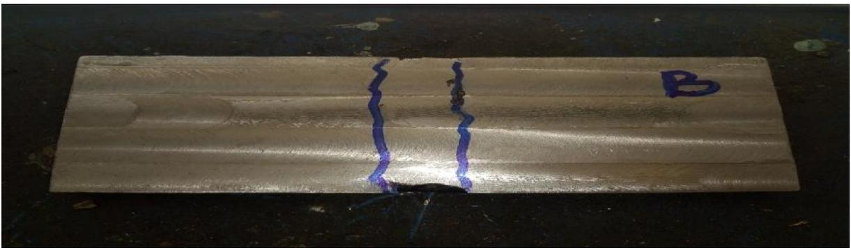
**Figure II.7**: forme de la maquette soudée avec EE du type basique après fraisage.
