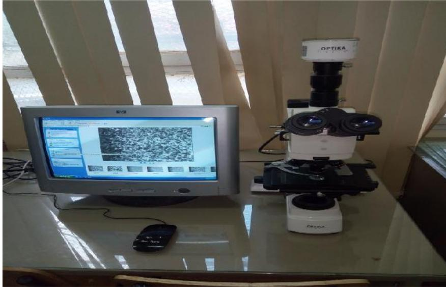
Figure II.15: Microscope optique piloté par ordinateur utilisé.
