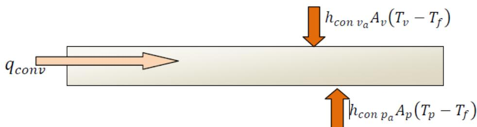
Figure II.16 : bilan énergétique au niveau de l'air qui traverse la cheminée
