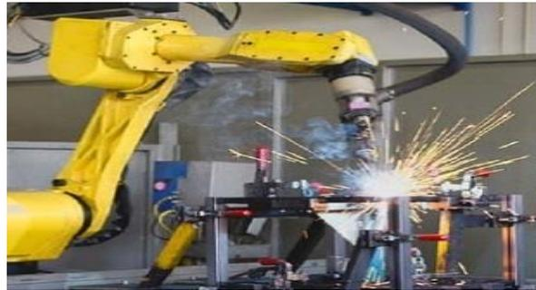
**Figure I.1.** Soudure effectuée par un robot.
