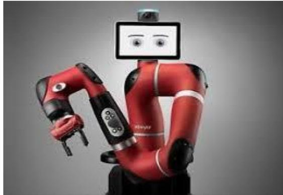
**Figure I.9.** Le robot collaboratif Swayer conçu par Rethink Robotics.
