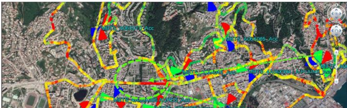
Figure 4.9 : L'effet d'overshooting au niveau du secteur 4A06X003_10.
