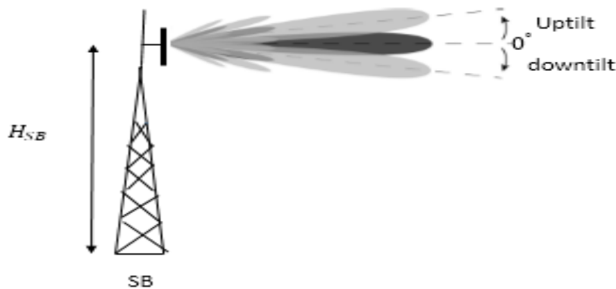
Figure 3. 4 : Illustration de l'Uptilt du Downtilt.
