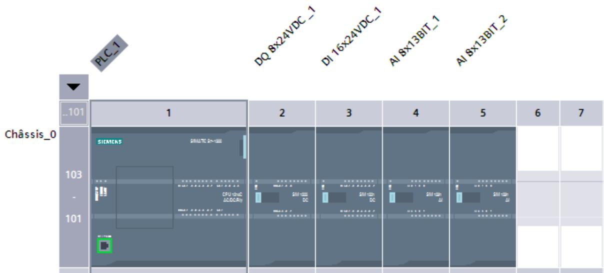
Figure III.15 : Représentation de notre automate S7-1214C
