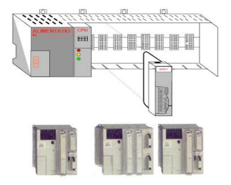
Figure III-2 La structure générale d'un automate modulaire
