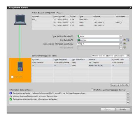
Figure V-17 Création d'une liaison entre l'automate et le TIA portal
