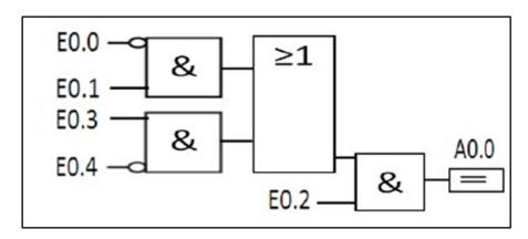
Figure V-3 Exemple de langage logigramme.
