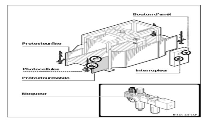
Figure IV-2 Dispositif générale de la sécurité
