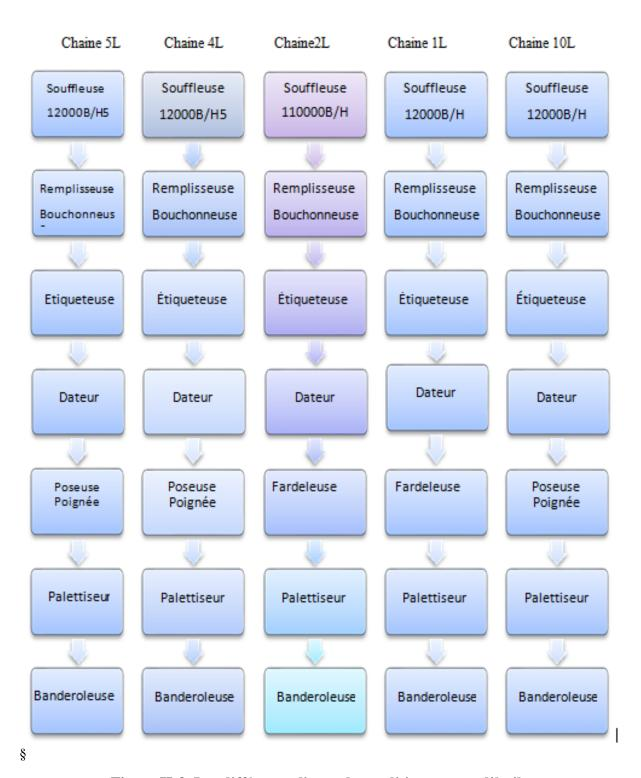
Figure II-3 Les différentes lignes de conditionnement d'huile.
