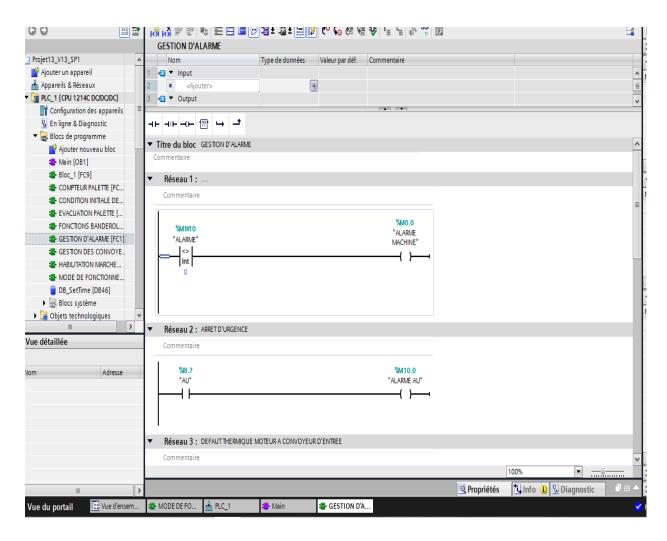
Figure V-10: Bloc de fonction (FC).
