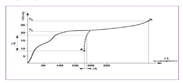
Figure IV-4 : évolution de l'allongement du film en fonction de la force
