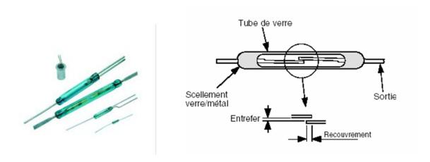
Figure IV-14: capteur magnétique.
