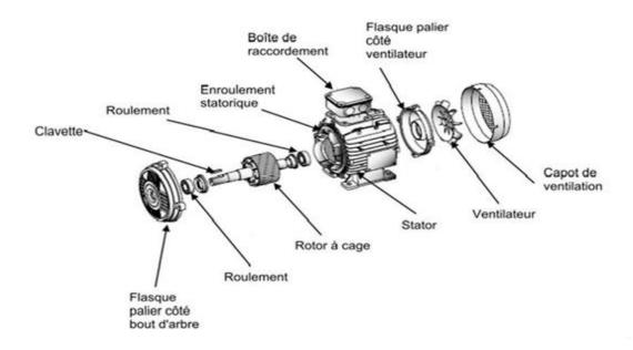
Figure IV-8 : moteur asynchrone a cage d'écureuil.
