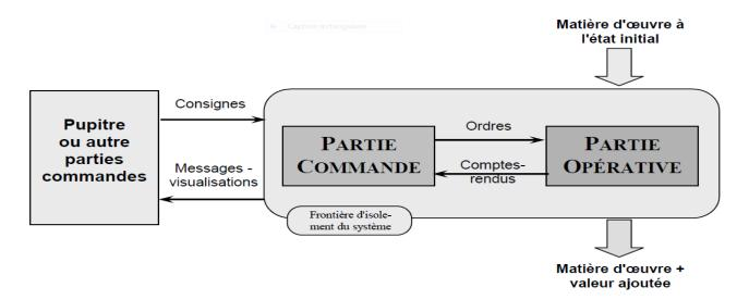
Figure V-1 Structure d'un système automatisé
