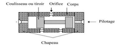
Figure IV-17 Distributeur pneumatique
