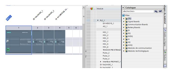
Figure V-6 Présentation de l'API et des modules entrées/sorties
