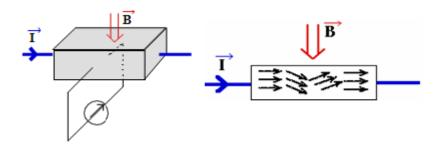
Figure IV-15: principe de l'effet HALL.
