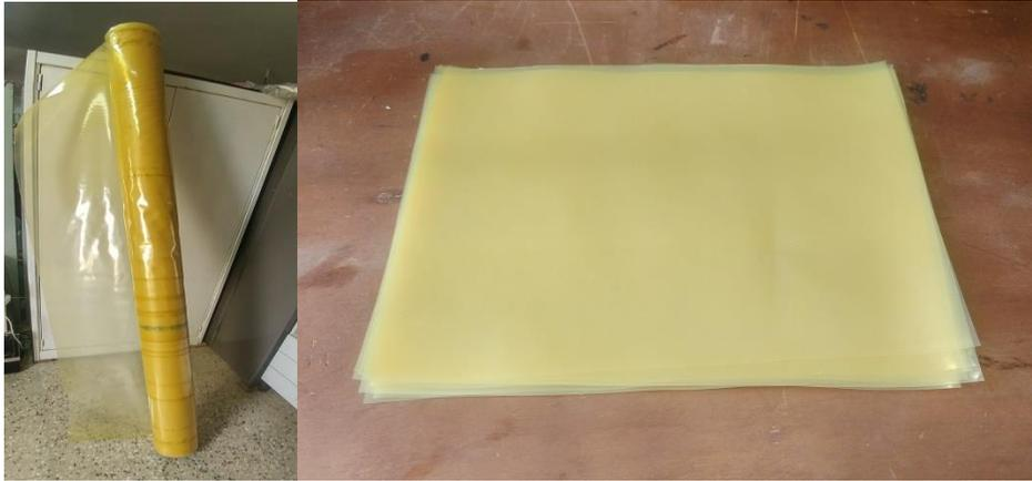
Figure III- 1 Eprouvettes utilisées pour les essais de claquage
