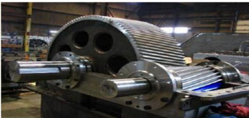
Figure I.12 : Schéma de la structure générale d'un réducteur à arbres parallèles.
