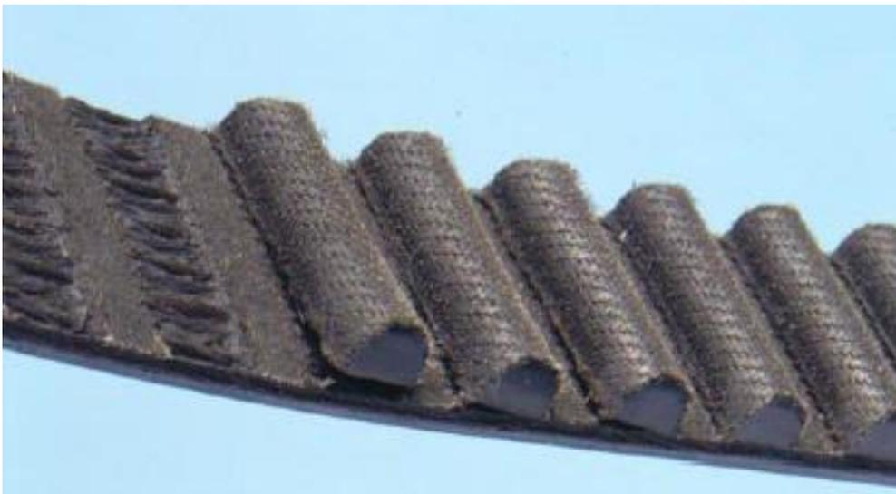
Figure (II.9) : Défaut de courroie « Partie arrachée ». [10]
