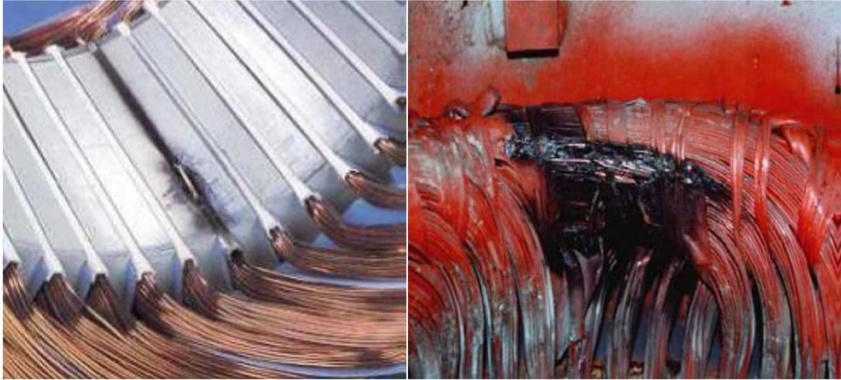
Figure (II.10) : Exemples de dégâts dus au défaut de court-circuit statorique d'un moteur asynchrone. [11]
