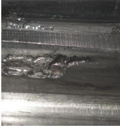
Figure (II.4) : Écaillage ou spalling.
