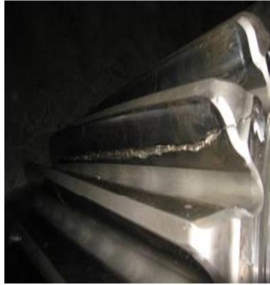
Figure (II.5) : Fissuration ou cracks « engrenage ».
