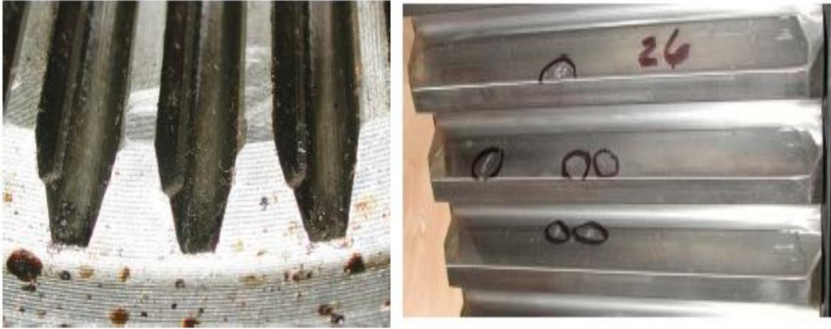
Figure (II.2) : Usure abrasive « engrenage ». Figure (II.3) : Pitting ou piqûres « engrenage ».
