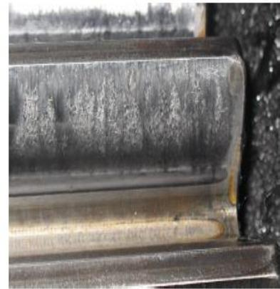
Figure (II.6) : Grippage « engrenage ». [8]
