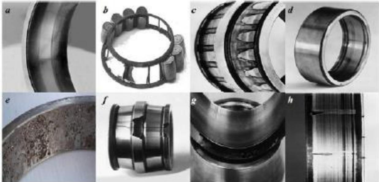
Figure (II.8) : Quelques défaillances affectant les roulements a- Usure généralisée b- Cage détériorée c- Corrosion d- Présence de cratère e- Ecaillage f- Fissure ou cassure g- Grippage h- Traces d'empreintes. [8]
