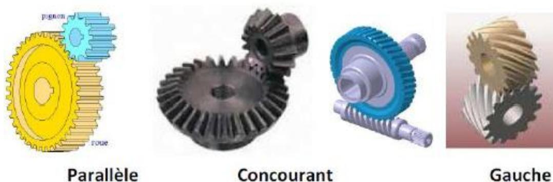
Figure (II.1) : Différents types d'engrenage. [9]
