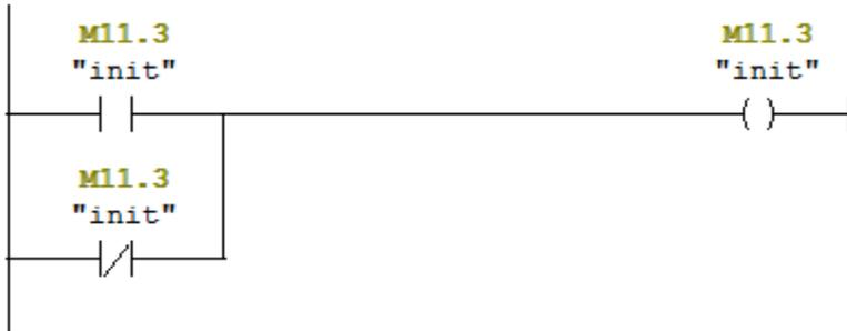
Pour l'insertion des boutons d'arrêt d'urgence (AU) et réinitialisation( **Réinit**) chaque équation logique de l'étape doit être multiplié fois  $[(\overline{AU}).(\overline{Réinit})]$ ,sauf l'étape initiale (X0).
