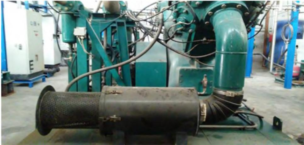
**Figure II. 3 :** Filtre à air.
