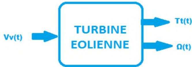
Figure II.6 : Entrées et sorties du modèle de la turbine éolienne
