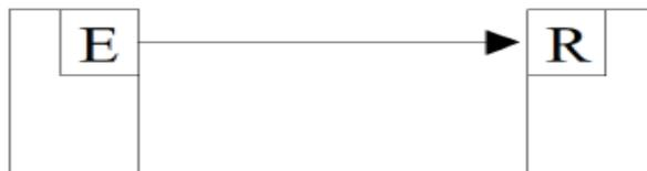
**Figure I.18 :** Détecteur type barrage.
