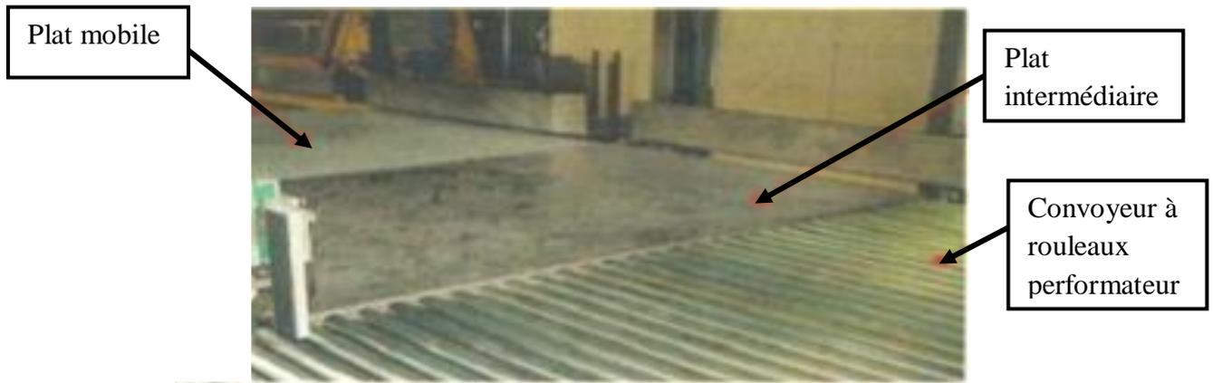
**Figure I.5 :** Image du plat intermédiaire et du plat mobile.
