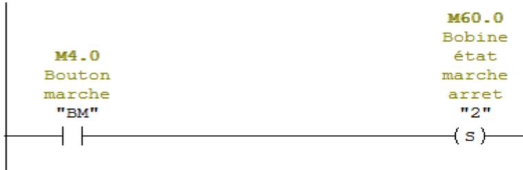
Réseau 2 : desactivation Bobine état marche arret, activation bobine d'arret
