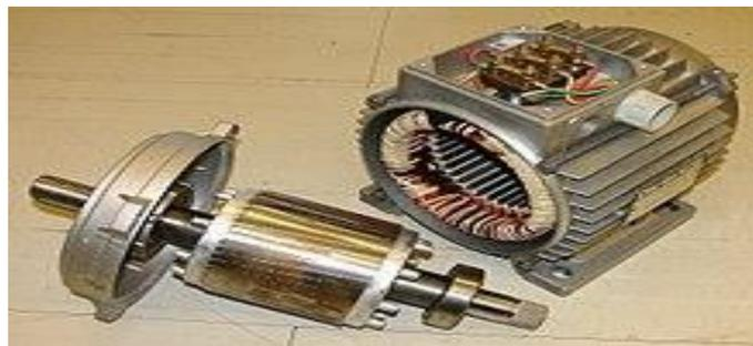
**Fig. I. 10** Machine asynchrone à cage d'écureuil
