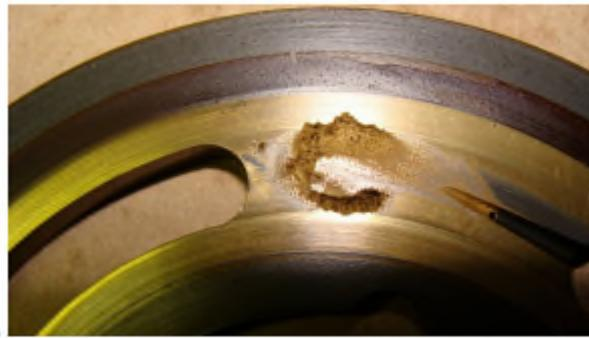
**Figure (II.8) :** usure due au phénomène de la cavitation.
