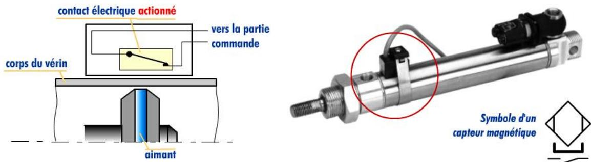
Figure (I.8) : Fonctionnement d'un capteur magnétique [7].
