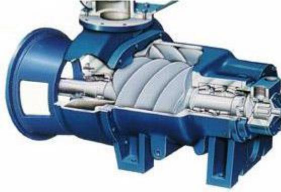
Figure (I.2) : Compresseur à vis [4].
