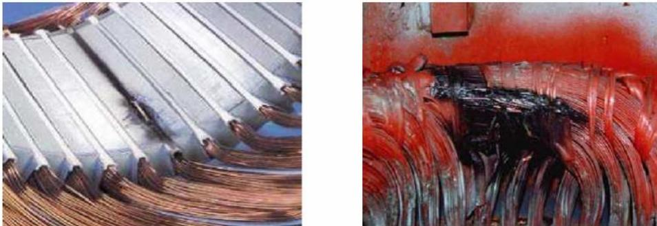
**Figure III.3** Exemples des dégâts dus au défaut de court-circuit statorique
