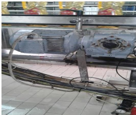
**Figure III.14** Moteur asynchrone triphasé.
