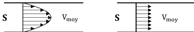
Figure I-7 : Profile de vitesse moyenne d'écoulement
