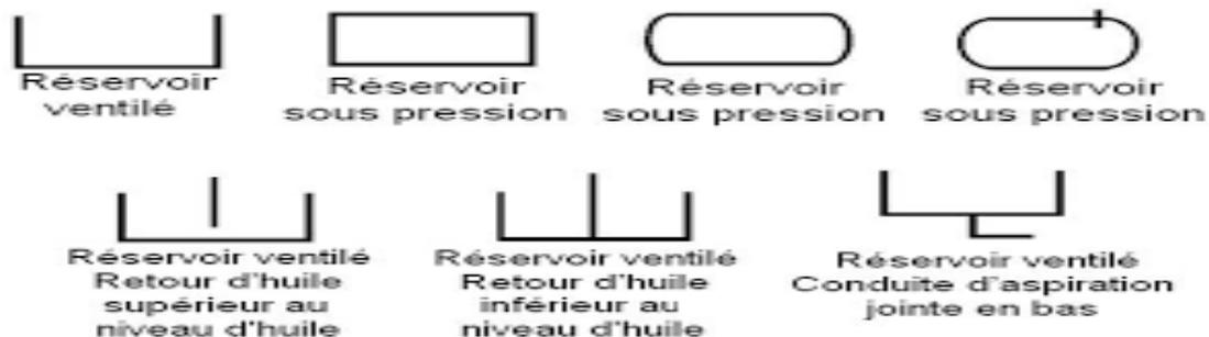
Figure II-6 : Les différents modèles des réservoirs hydrauliques
