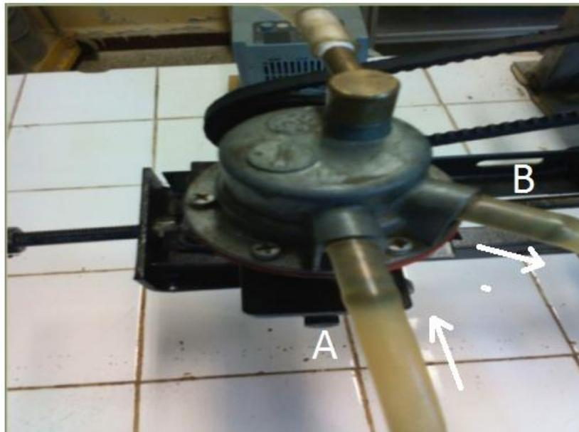
**Figure III-7 :** Pompe à membrane
