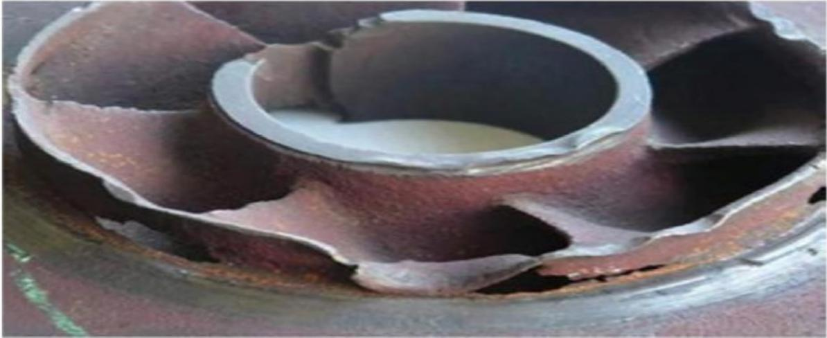
**Figure II-7** : Photo illustrant de cavitation sur un impulser
