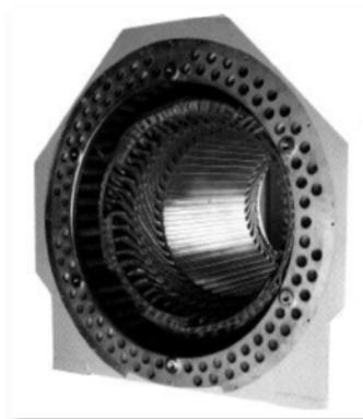
**Figure I.1:** Stator d'une machine synchrone.
