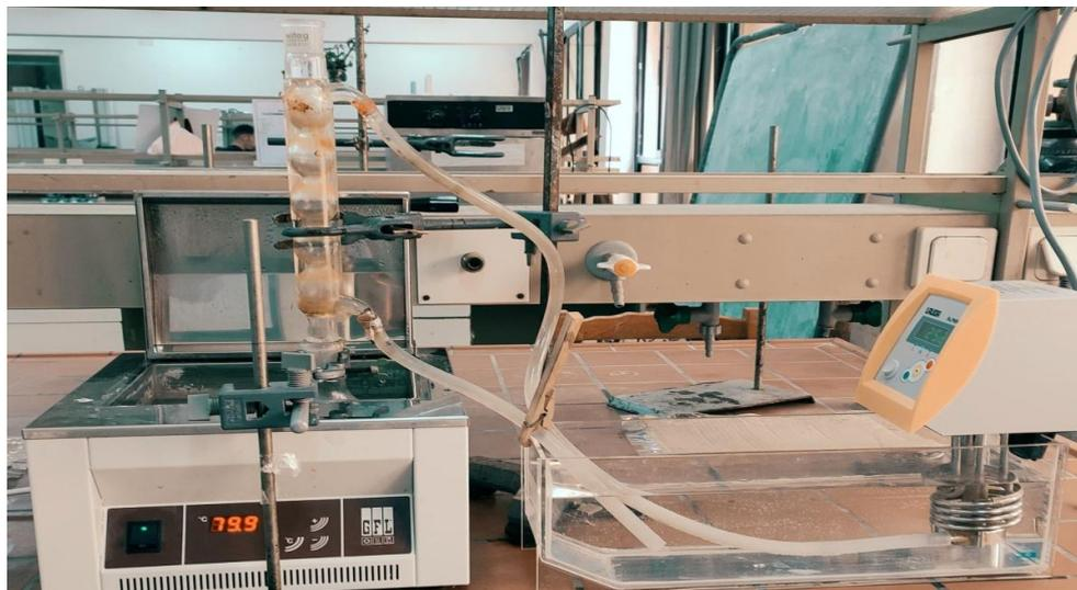
Figure II.5 : Montage d'élimination de l'hémicellulose
