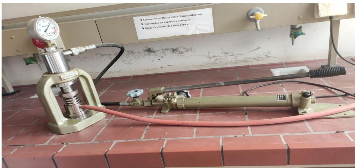
Figure II.10 : Montage de la presse hydraulique
