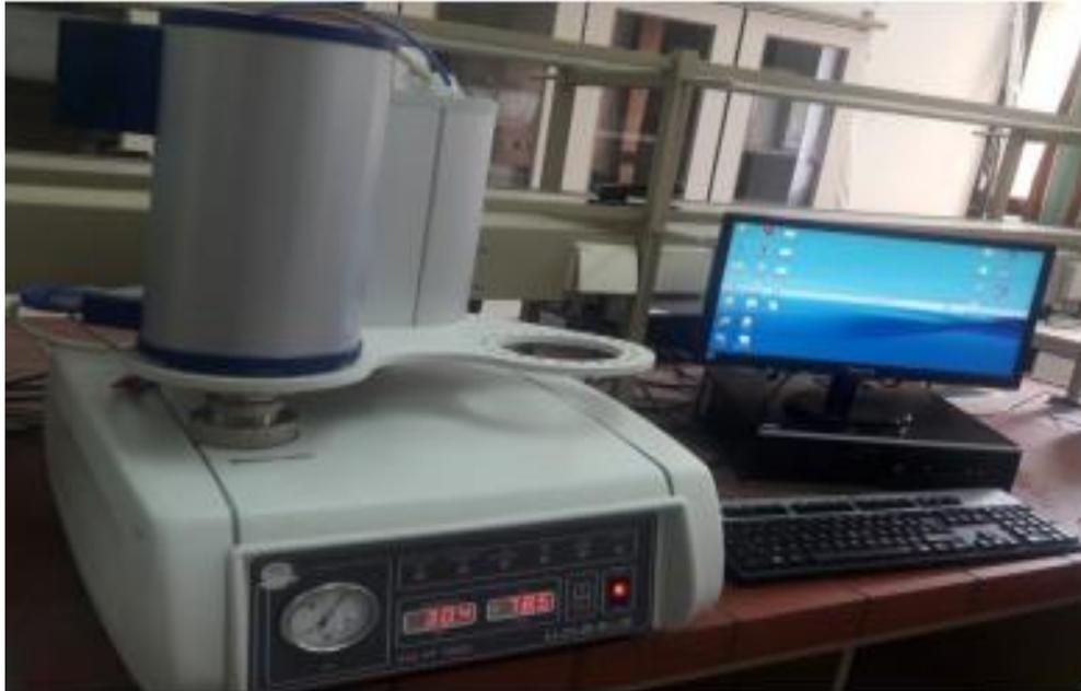
Figure II.11 : Photographie de l'appareille de l'ATG utilisé
