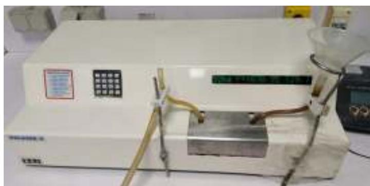
**Figure 10 :** Polarimètre.
