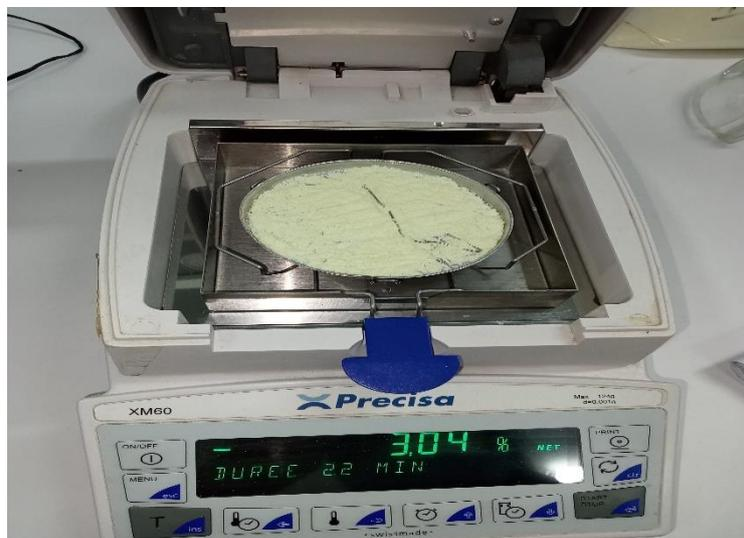
Figure N°12 : Mesure du taux d'humidité.
