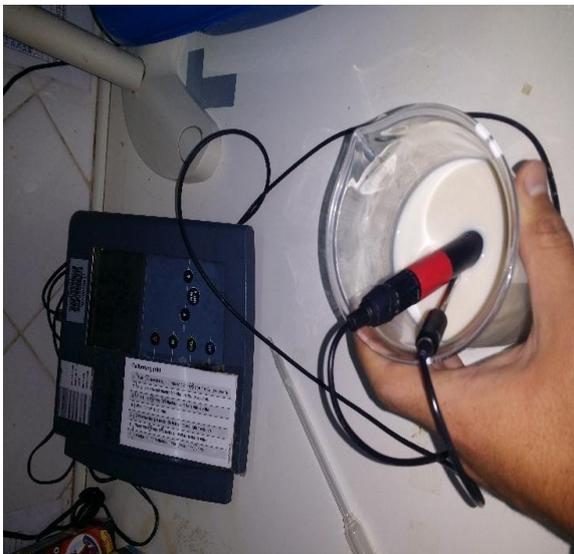
**Figure N°10 :** Appareil de mesure du pH de lait.
