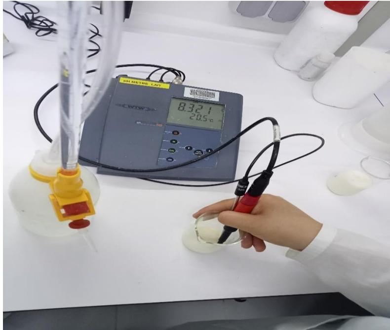
**Figure N°17** : Détermination de l'acidité titrable.
