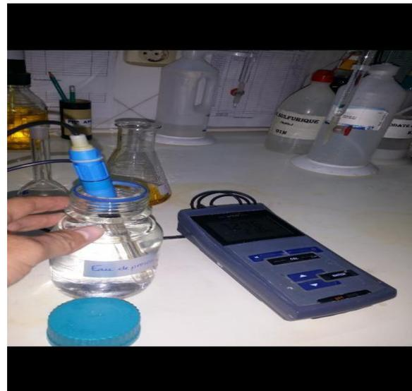
**Figure N°11 :** Appareil de mesure du pH de l'eau de process.
