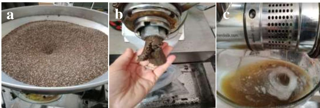
**Figure II.4 :** Le procédé d'extraction à froid de l'huile de chia : graines dans l'entonnoir (a) ; tourteau (b) ; huile sortie des fentes (c).
