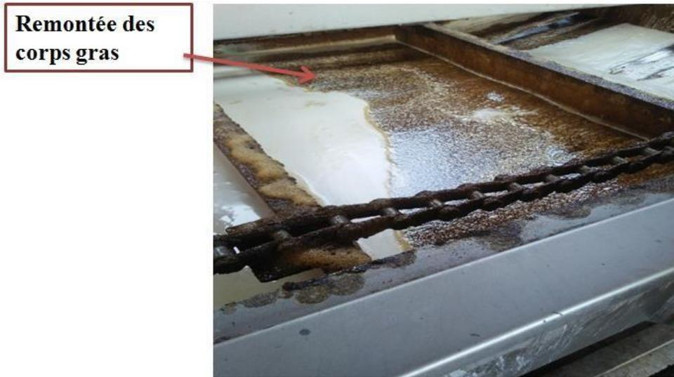
**Figure 23-** Traitement physico-chimique : flottation.
