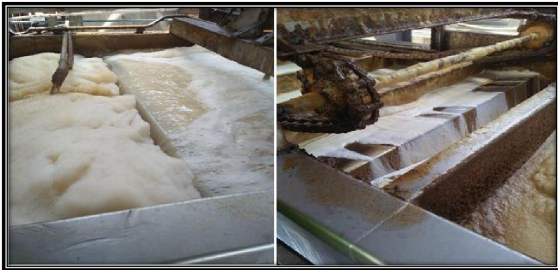
**Figure 22-** Traitement physico-chimique : à gauche coagulation ; à droite floculation.
