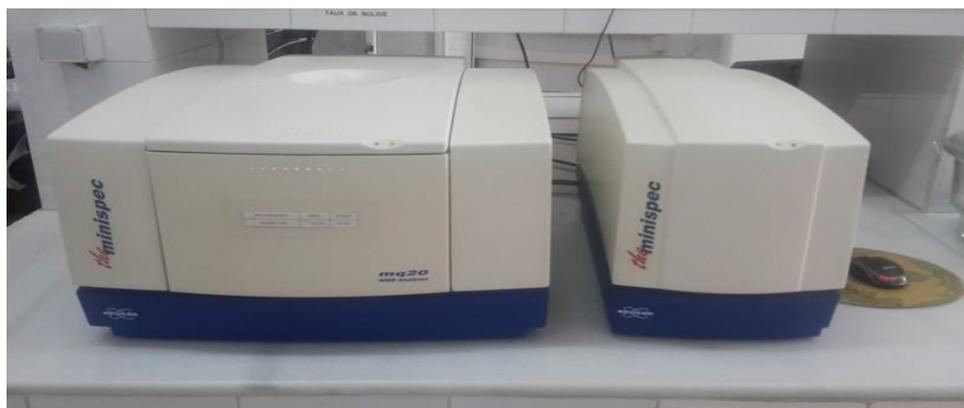
**Figure 12** : Spectromètre de résonance magnétique nucléaire (RMN).
